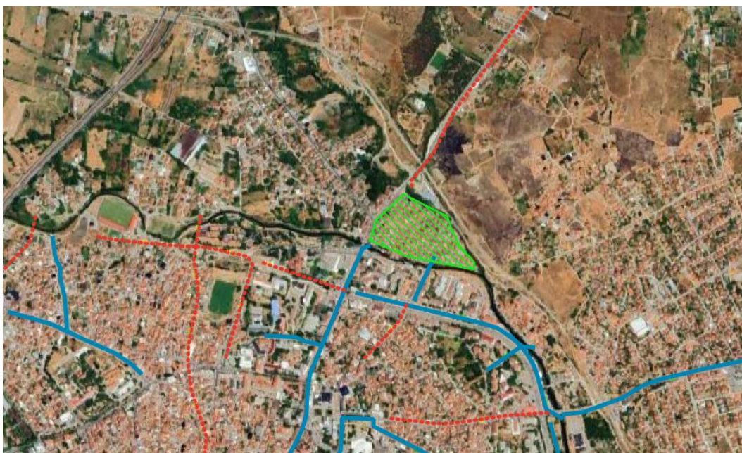
Слика 33: Препорачана е дополнителна мрежа за атмосферски води во зелената зона
